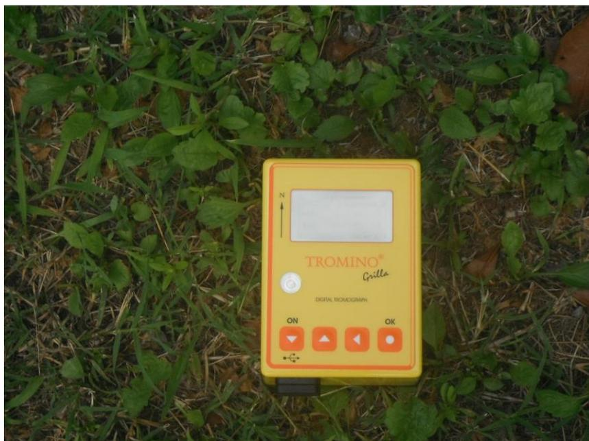
Strumentazione usata per prova sismica passiva. Tromino® By Micromed S.p.A.
